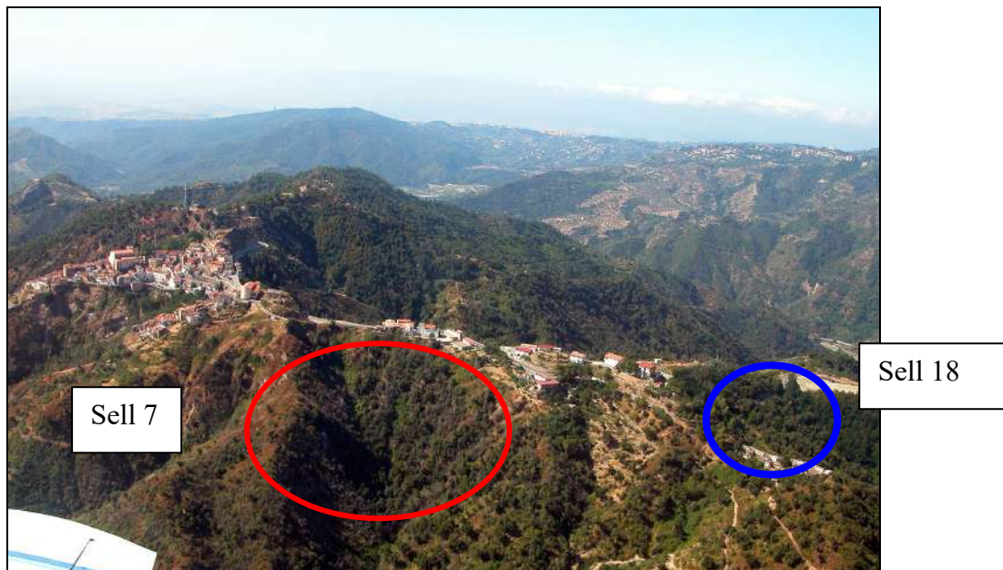
Foto 12: Versante esposto a nord del settore occidentale con la presenza di Zone Franose profonde (SELL 7 e SELL 17) e per scorrimento (SELL 16 e 18)
